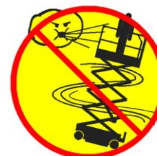
Betreiben Sie die Maschine nicht bei starkem oder böigem Wind. Die Oberfläche der Arbeitsbühne oder die Last darf nicht vergrößert werden. Eine Vergrößerung der dem Wind ausgesetzten Fläche verringert die Stabilität der Maschine.
